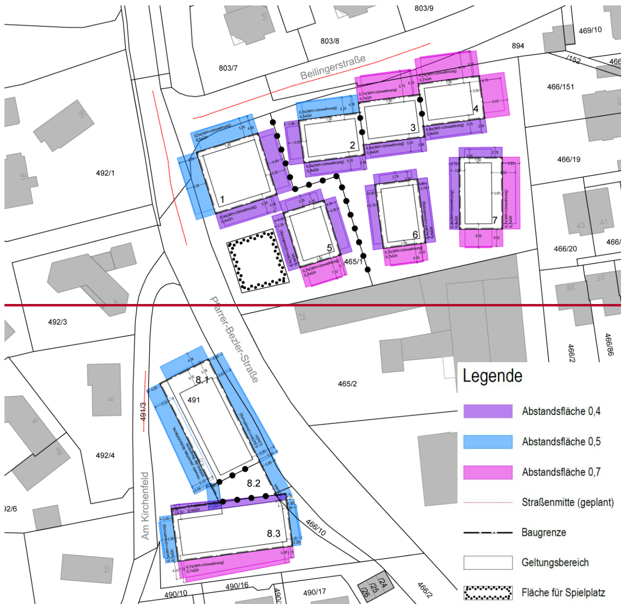
Abbildung 24: Abstandsflächenplan, i. d. Fassung vom 29.05.2026, o. M.
