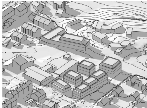
Abbildung 22: Verschattungsanalyse zum Bebauungsplanentwurf mit Blick nach Nordosten für den Tag 21.12. um 9 Uhr (oben links), 12 Uhr oben rechts und 15.30 Uhr unten links, o. M.
